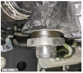
13. INSTALL THE PROVIDED INTERCOOLER BRACKET REUSING THE FACTORY HARDWARE. FIG. 16
