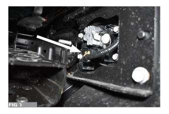
2. UNPLUG DRIVER SIDE BUMPER WIRE HARNESS FOUND IN TOP OF THE BUMPER. FIG. 2, 3
