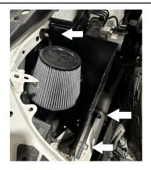
14. REINSTALL THE FACTORY AIR DUCT.
