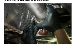
16. PLACE AND TIGHTEN THE SLIP JOINT
