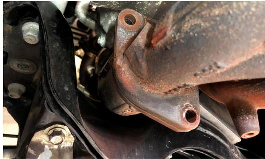
**5. REMOVE 6 14MM NUTS SECURING FACTORY MANIFOLD**
