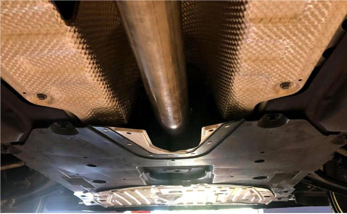
**2A-C. REMOVE THE MUFFLER FROM THE RUBBER HANGERS, AND REMOVE THE MUFFLER**
