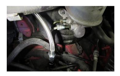
6. REMOVE BRAKE LINES FROM BRAKE MASTER CYLINDER, USE A 12MM LINE WRENCH TO PREVENT ROUNDING THE NUTS.
