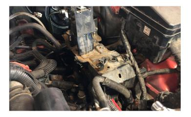
22. INSTALL SLAVE CYLINDER LINE WITH NEW BANJO BOLT AND TIGHTEN DOWN. WE RECOMMEND ROUTING THIS THE SAME WAY AS THE FACTORY LINE WAS ROUTED.
