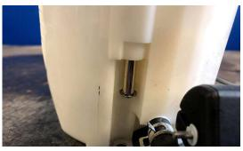
9. DISCONNECT OEM FUEL PUMP FROM THE TOP HAT BY UNPLUGGING THE WIRING HARNESS ON THE TOP OF THE PUMP (BLACK AND BLUE WIRES).
