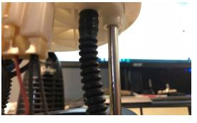
11. REMOVE RETAINING RING FROM FUEL PUMP ASSEMBLY BY LIFTING THE CLIPS ON THE SIDE THEN REMOVE PUMP/FILTER ASSEMBLY.
