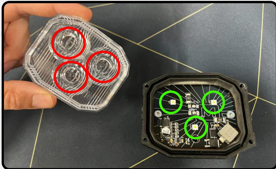
5. PLACE THE LENS HOLDER OVERTOP OF THE NEW LENS. MATCH THE ALIGNMENT LOCATORS ON THE HOLDER TO THE HOLES ON THE HOUSING. THE DESIGN ON THE SIDE OF THE HOLDER AND HOUSING SHOULD MATCH UP AS WELL
