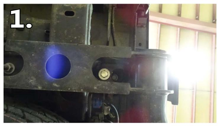
WITH THE FACTORY BUMPER REMOVED YOU CAN BOLT THE BED BACK DOWN TO THE FRAME.
