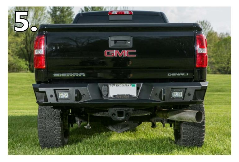
THE NEW BUMPER IS DESIGNED WITH ADJUSTABLE MOUNTS SO BE SURE TO SPEND MORE TIME PROPERLY ALIGNING THE BUMPER. THE BUMPER WILL HAVE SIDE-TO-SIDE AS WELL AS UP AND DOWN ADJUSTMENT. ONCE THE BUMPER HAS BEEN PROPERLY ALIGNED BE SURE TO TIGHTEN ALL THE BOLTS SO IT DOESN'T MOVE.
