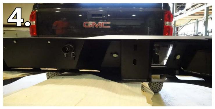
BEFORE INSTALLING THE NEW BUMPER, IT IS EASIER TO INSTALL THE TRAILER PLUG, REVERSE SENSORS, AND LIGHTS.
