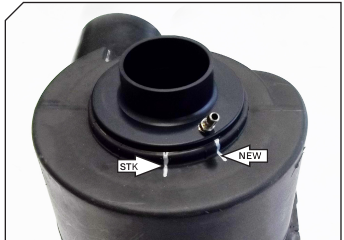
INSTALL DYNOJET FLANGE
