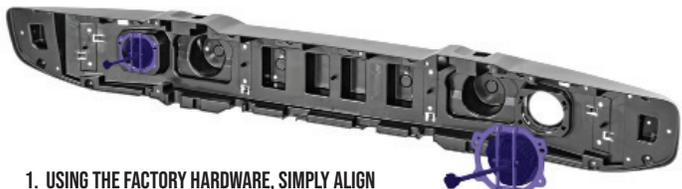
1. USING THE FACTORY HARDWARE, SIMPLY ALIGN THE FOG LIGHT AND FIX INTO POSITION.
