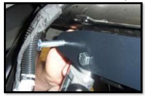
14. Place a (JJ) spacer onto the bolt.
