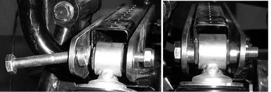
16) Secure it using a 10mm lock nut.
